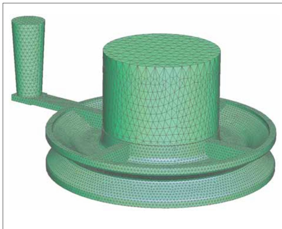
Рис. 2. КЭ-модель литейного блока, полученная в CAD-системе Unigraphics (ОАО «Салаватнефтемаш»)
