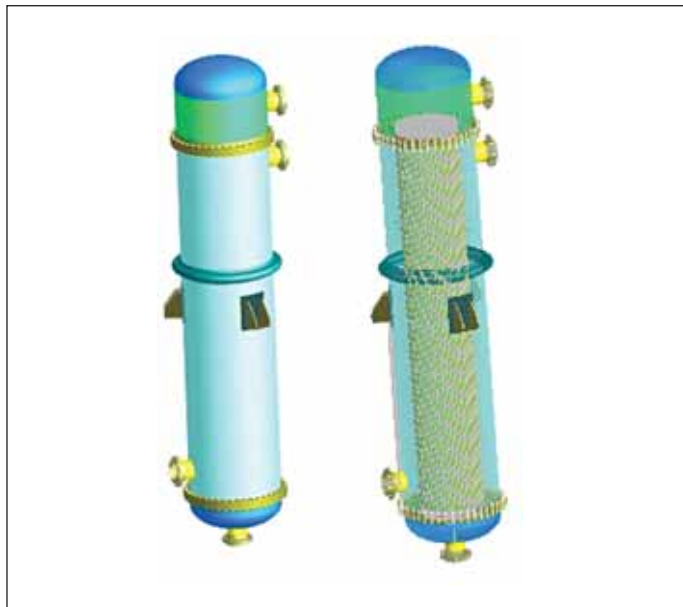
Рис. 4. Вертикальный аппарат с компенсатором
