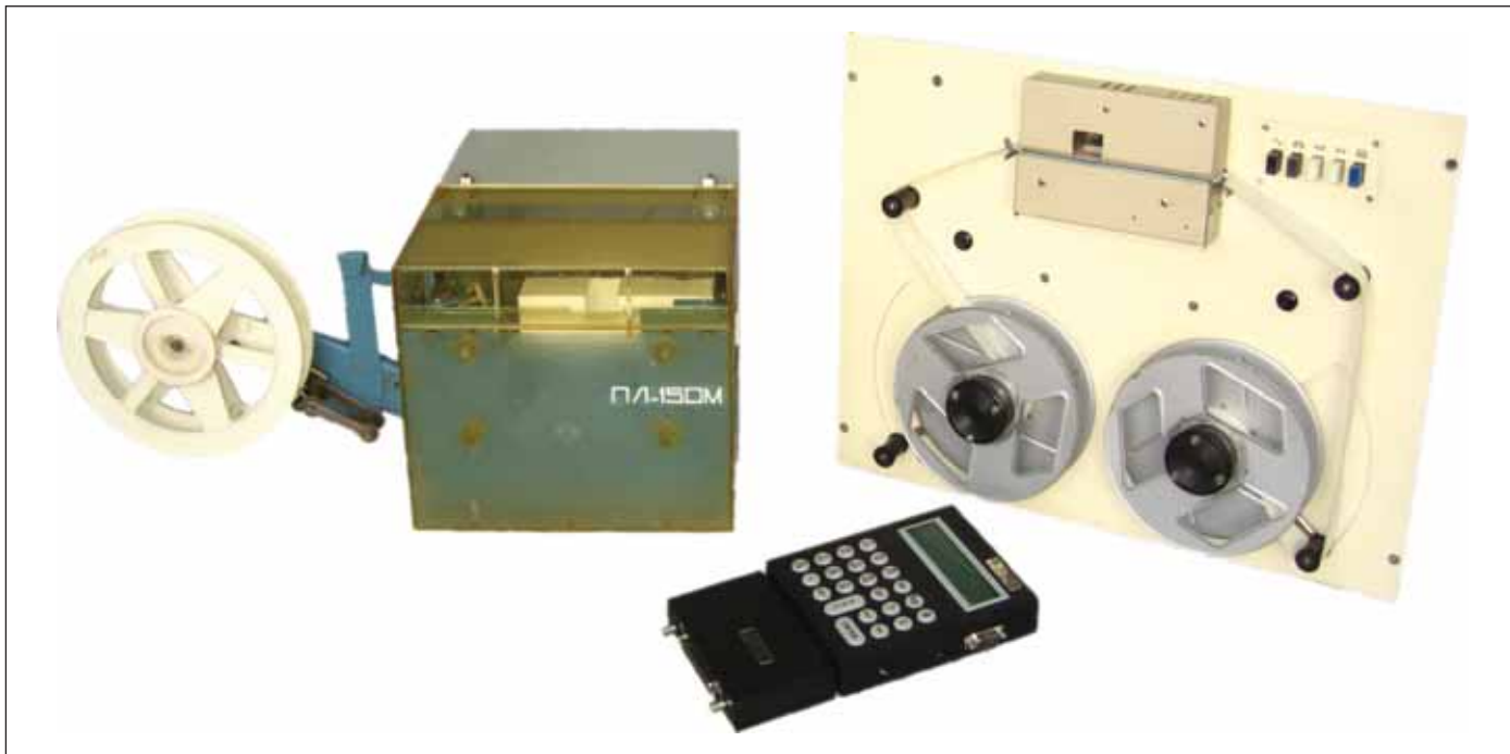
Рис. 4. Блок электроники ЭСЗУ-К с интерфейсной вставкой и фотосчитыватель CONSUL-337.601 с перфоратором ПЛ-150М. Фотосчитыватель с перфоратором весит 34 кг, потребляют мощность 340 Вт, а их цена составляет 40 978 руб. Блок электроники с интерфейсной вставкой весит 0,55 кг, потребляет 0,4 Вт и стоит 20 125 руб.
