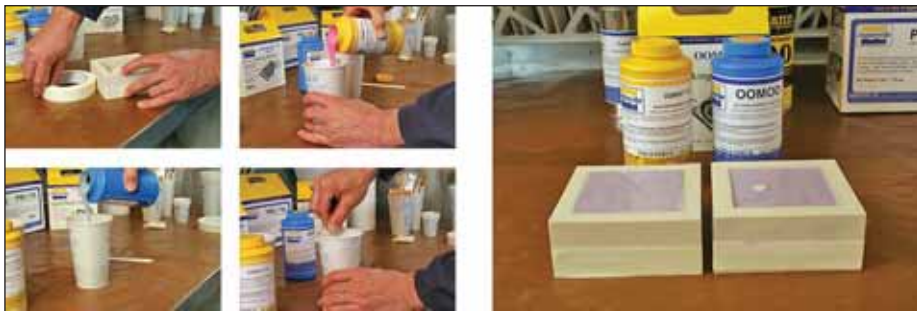
Процесс изготовления эластичной формы
