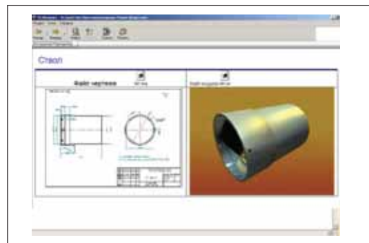
Рис. 12. Размещение в ИЭТР файлов чертежа и виртуальной 3D-модели
