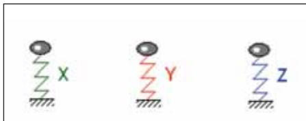
Рис. 6. Элемент 51 для моделирования работы РМСО
