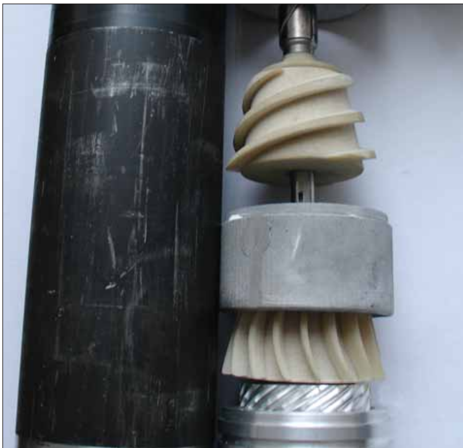
Рис. 5. Сборка прототипа насоса
