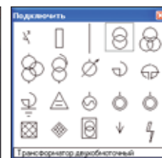
Рис. 2. Палитра объектов электрической сети, подключаемых к узлу схемы (окно ввода)
