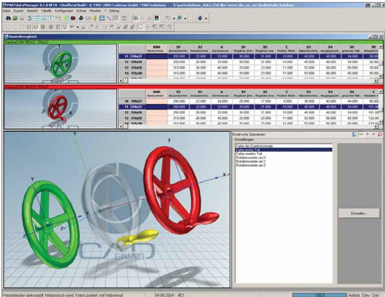
чеством отверстий или одинаковые болты разных размеров), во втором – только похожие компоненты одинакового размера. Компоненты будут структурированы по степени похожести и мы сможем уточнить геометрическое отличие одного компонента от другого (скажем, два диска: один с ручкой, а другой – без ручки).
