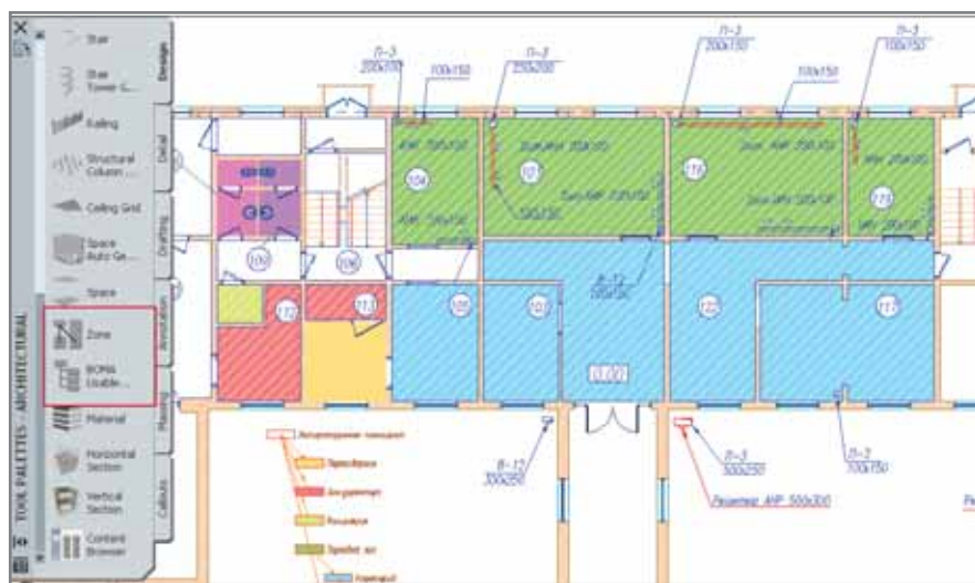
Рис. 19. Цветовая схема помещений с применением инструмента "Зоны"
