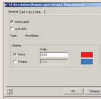
Рис. 8. Задание опции отображения усилия при симуляции
