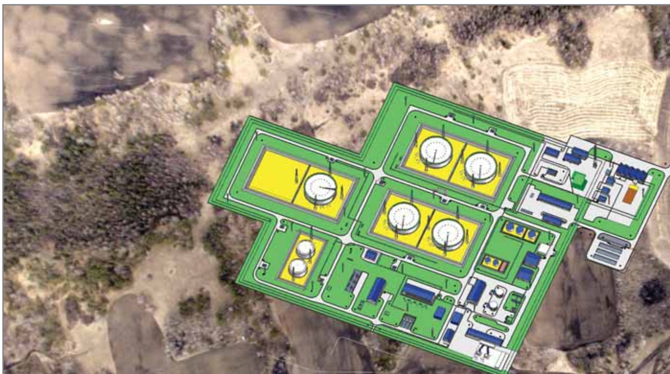
Рис. 11. Проекционное наложение варианта компоновки НПС с реальным рельефом местности
