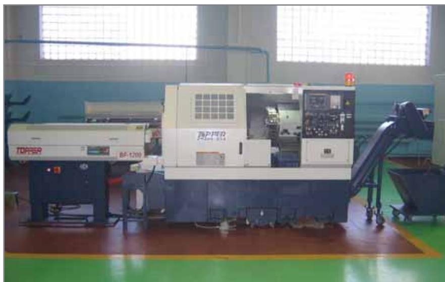
Рабочее место патронно-центрового станка с ЧПУ TNL-85A с прутковым податчиком BF1200
