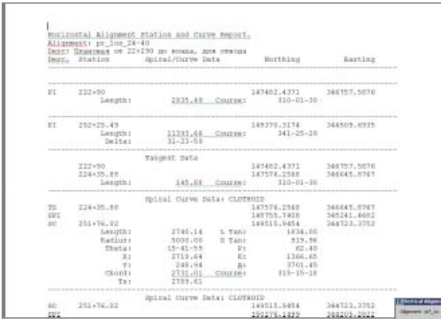
Рис. 8. Вывод параметров плановой осевой в текстовый файл
