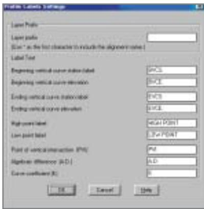
Рис. 14. Назначение обозначений элементов продольного профиля
