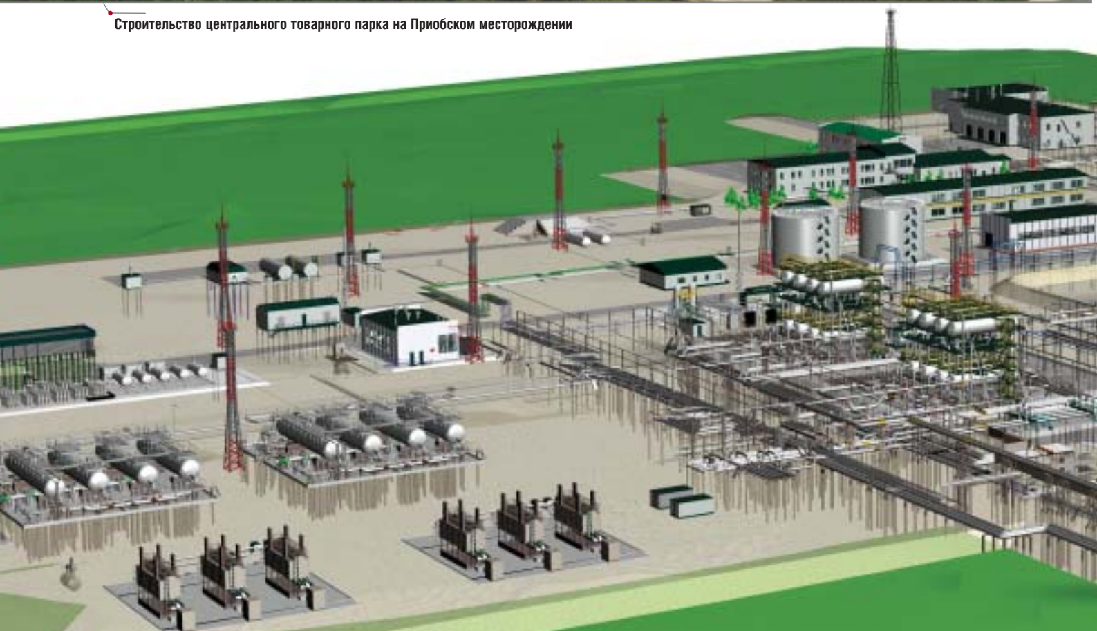
Вариант трехмерного генплана площадки центрального товарного парка с проработкой инженерных сетей на Приобском месторождении
