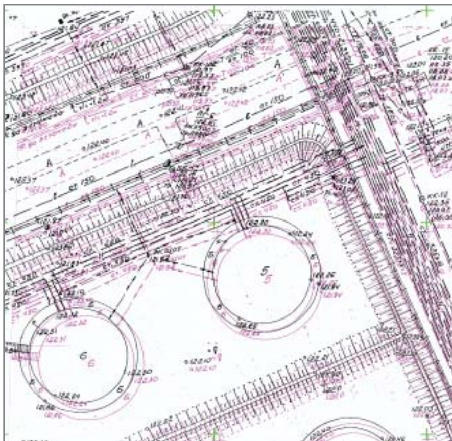
Пример калибровки. Пурпурное изображение – до калибровки, черное – после
