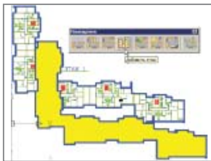
Рис. 25. Определение контура площади этажа
