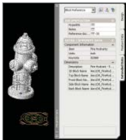
Рис. 7. Редактирование свойств блока компонента с помощью окна свойств
