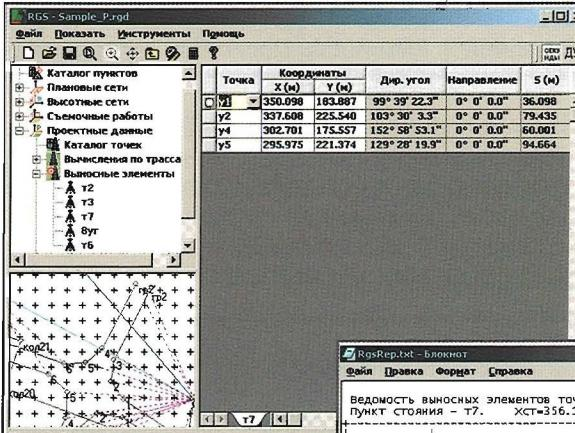
Для просмотра пунктов, подобранных программой в качестве пунктов стояния, следует выбрать в дереве навигации "Выносные элементы". Для просмотра и редактирования выносных элементов необходимо выбрать в дереве навигации нужный пункт стояния. Для получения ведомости выносных элементов выделяются пункты стояния и нажимается кнопка *Отчет*.
