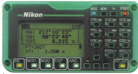
Рис. 3. Приборная панель тахеометра Nikon DTM-352
