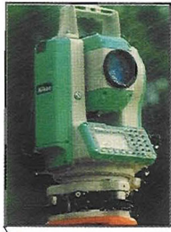
Рис. 2. Тахеометр Nikon DTM-352
