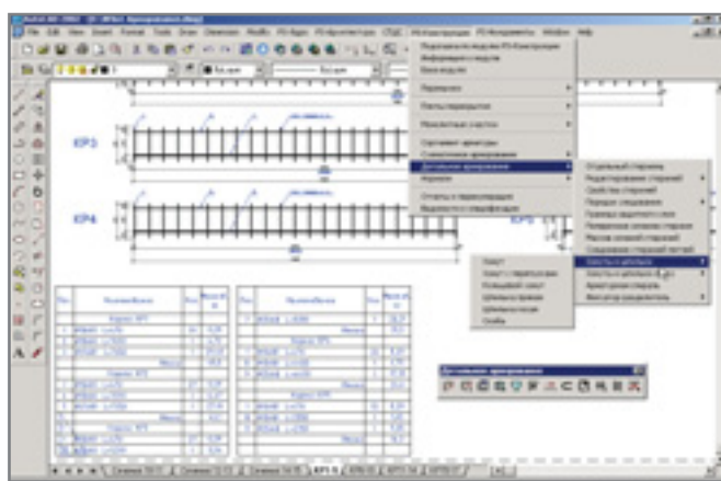
Рис. 15. Пример детального армирования
