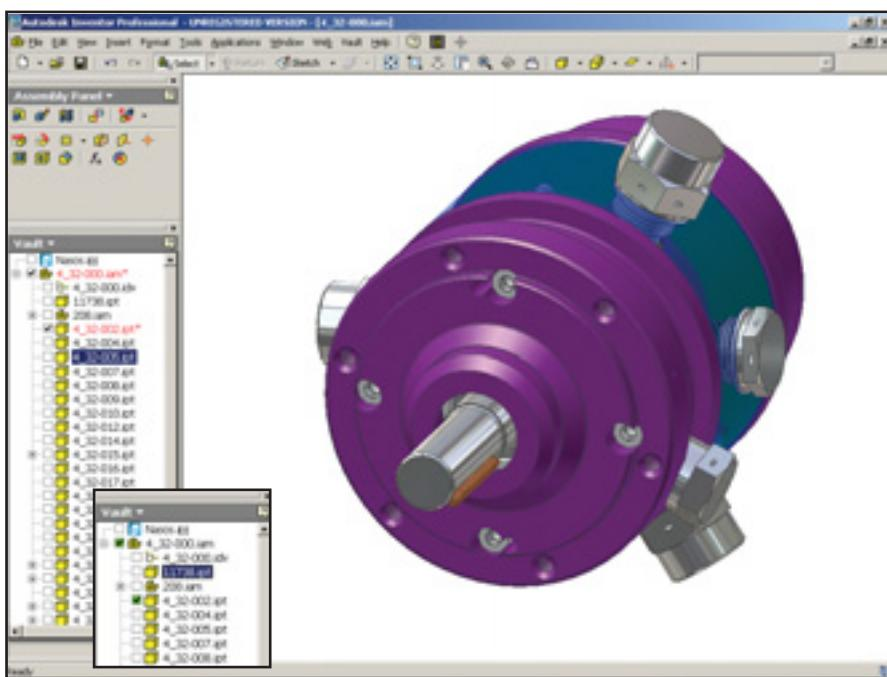
↑ Редактируем количество отверстий в корпусе и обновляем ассоциативный массив винтов. В дереве Vault мы сразу увидим выделенные красным цветом изменения соответствующей детали и изделия. В дальнейшем Vault будет отмечать в дереве любое изменение контролируемых файлов
