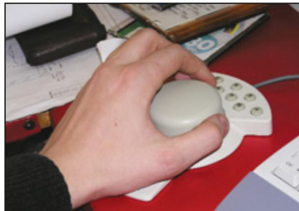
Рабочий орган (2) манипулятора имеет шесть степеней свободы (три линейных и три угловых). Трехмерная модель, отображаемая на экране, повторяет его движения. Скорость перемещения трехмерной модели вдоль соответствующего направления определяется интенсивностью физического воздействия на ту или иную ось.
