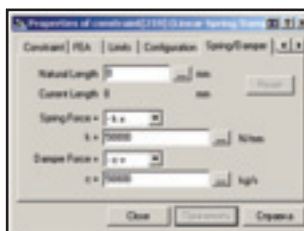
Рис. 8. Меню visualNastran Desktop 4D для определения свойств податливости опор
