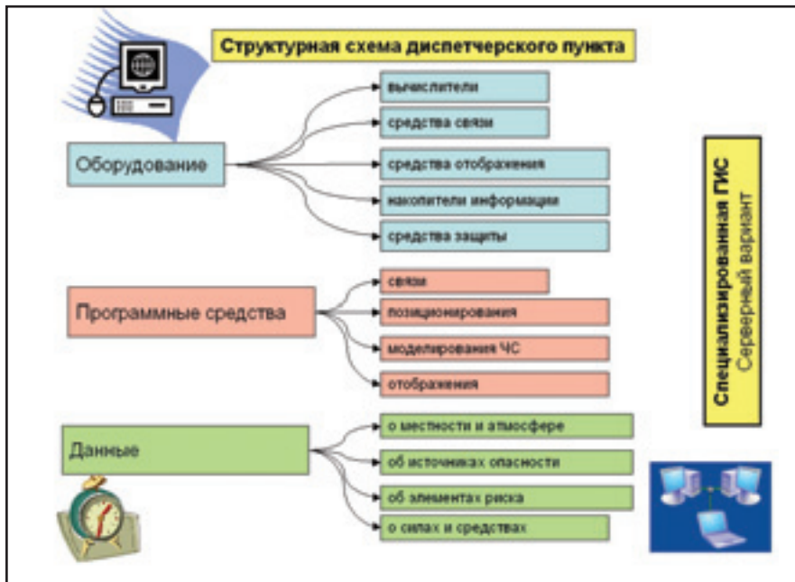
▲ Рис. 3. Структурная схема диспетчерского пункта
