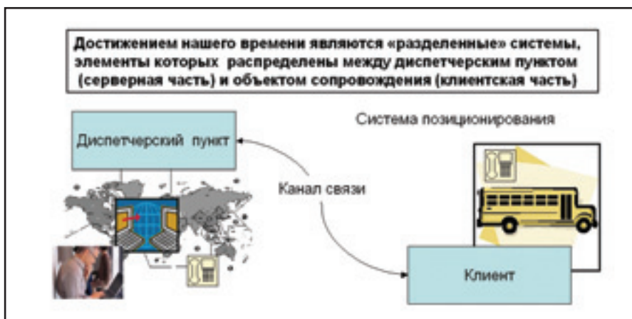
▲ Рис. 2. Принципиальная схема разделенной МТСП
