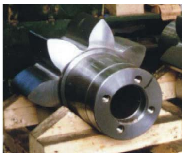
▲ Детали редуктора механизма подъема самоподъемной буровой установки
