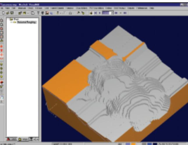
быть сохранена. Библиотека поставляемых постпроцессоров может быть пополнена при помощи Visual-генератора, в нашем случае достаточно было отредактировать постпроцессор FANUC (переключили его с дюймов на миллиметры) для того, чтобы станок ALPHA Cielle "понимал" сформированную программу в G-кодах.
