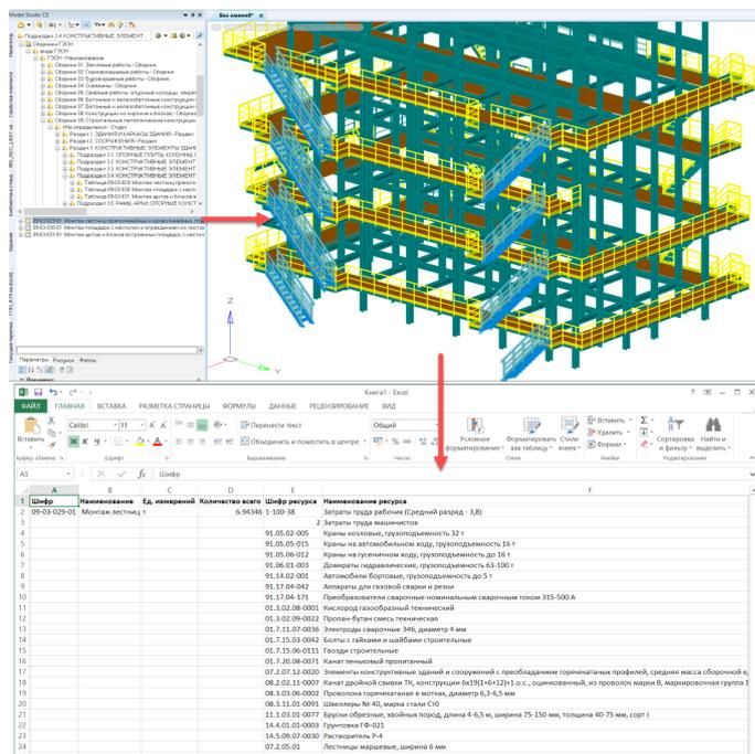
Рис. 18. Экспорт сметных свойств в формат XML
