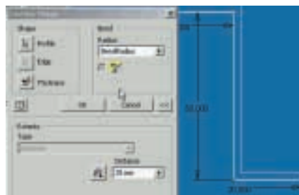
Задание толщины контура и его вытягивание из незамкнутого эскиза
