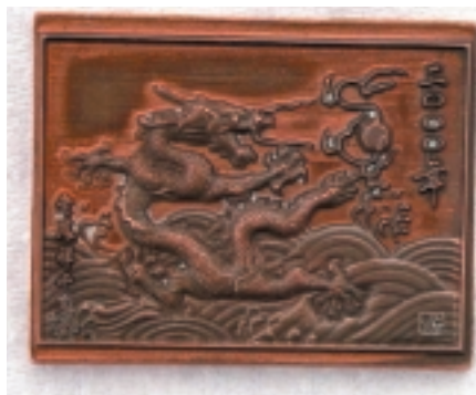
Литевая форма и отливка элемента декоративного оформления
