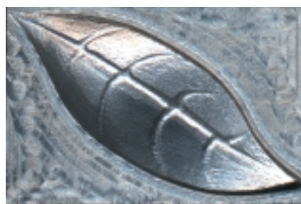
Пример фрезеровки стальной заготовки в масштабе 2:1
